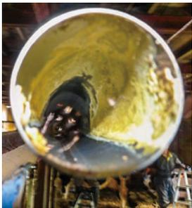
写真② ミルクラインに固着した乳石
