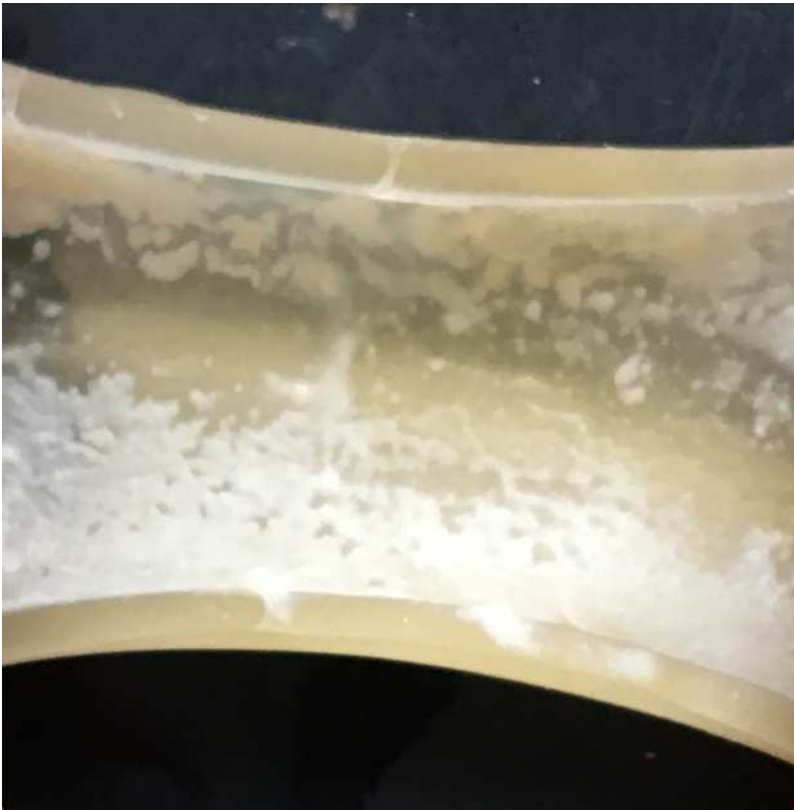
写真 2 : ホース内部にミルクが固着してしまうと洗浄しても取れず、交換が必要になります。
