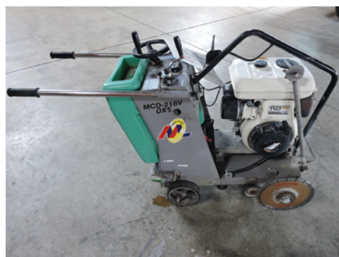
コンクリートカッター
