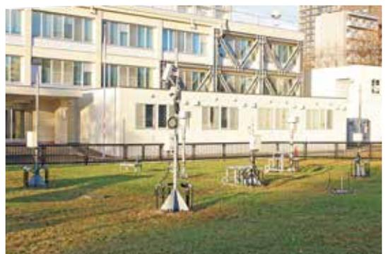
気象台前の観測露場に設置されている観測機器。札幌市のデータはこちらの機器で観測している
